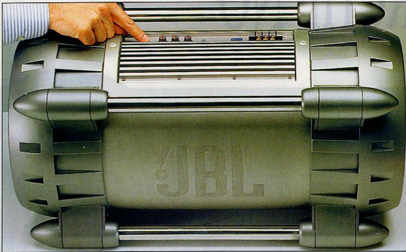
Questa immagine mette in evidenza la struttura del BTX-250: il box misura 625 mm di lunghezza. Si notino i tubi tensori in acciaio, che conferiscono rigidità e robustezza al diffusore e, per mezzo degli agganci forniti in dotazione, consentono di fissarlo sul fondo del bagagliaio.
